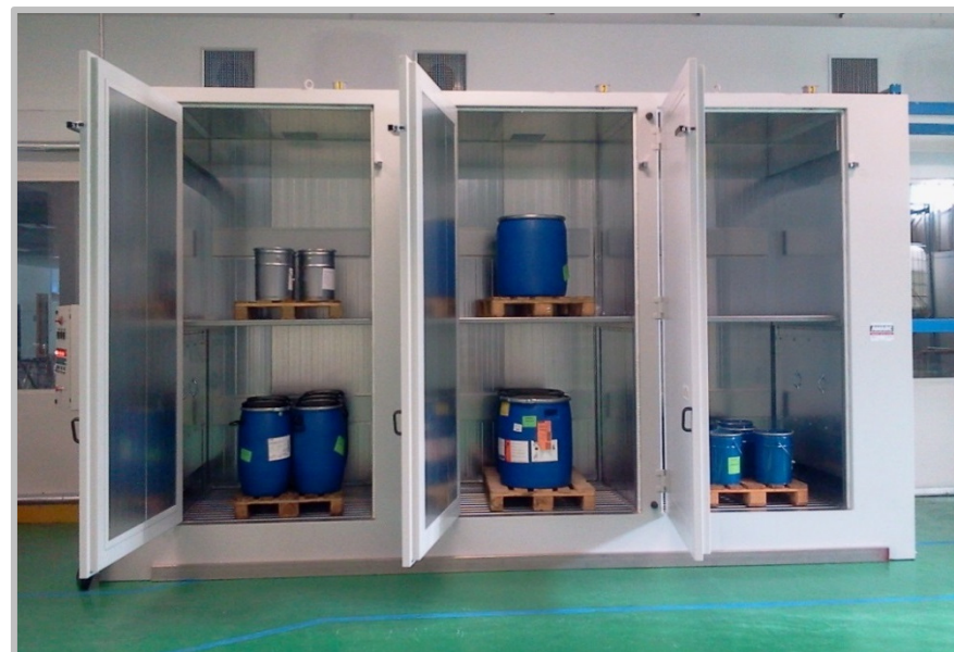
Varmeovn til 24 tromler, opdelt i 3 kamre til hver 8 tromler. Temperatur op til 100°C, drevet af damp og med opsamlingskar.
