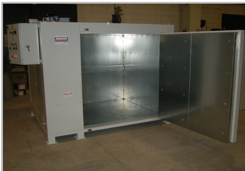
Varmeovn til 4 tromler, op til 150°C, elektrisk drift, med bundramme på ben.
