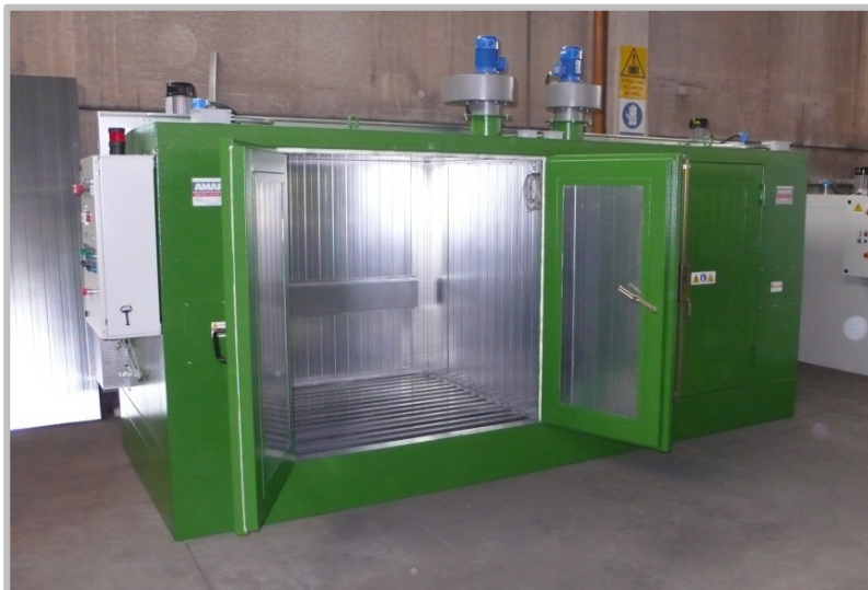
Varmeovn til 8 tromler med EUR kamre, opdelt i 2 kamre til hver 4 tromler. Elektrisk drevet, med temperatur op til 100°C. Med opsamlingskar og udsugningssystem.
