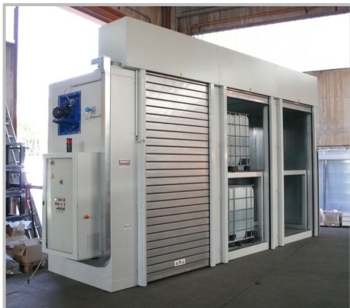
Varmeovn til 24 tromler, elektrisk drevet, med temperatur op til 80°C. Fjernbetjente rulle døre og opsamlingskar.
