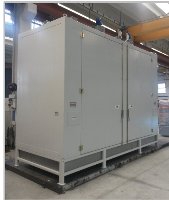
Varmeovn til 16 tromler, opdelt i 2 kamre til hver 8 tromler. Elektrisk drevet, med temperatur op til 150°C. Bundramme på ben med opsamlingskar. Paneler i rustfri stål (AISI304), monteret med udsugningssystem og døre, der går i indgreb.
