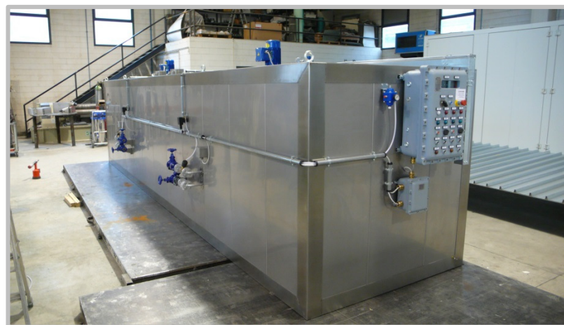
(2/2) Bagside Horisontal varmeovn til 16 tromler, opdelt i 2 kamre til hver 8 tromler. Drevet af damp med temperatur op til 150°C. ATEX godkendt og AISI304 Rustfri stål konstruktion.
