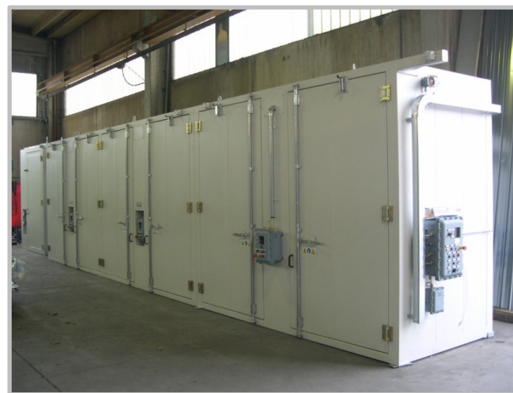
Varmeovn til 48 tromler, opdelt i 3 separate rum, hver til 16 tromler. Drives af damp, temperatur op til 150°C, Atex godkendt.
