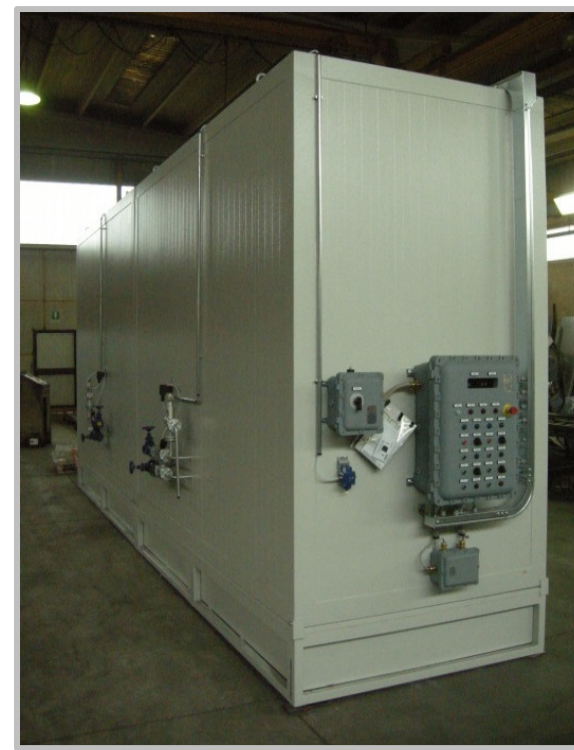
(2\2) BAGSIDEN Horisontal varmeovn til 32 tromler, opdelt i 2 separate kamre til hver 16 tromler. Temperatur op til 150°C, drevet af både el og damp. ATEX godkendt og med opsamlingskar.
