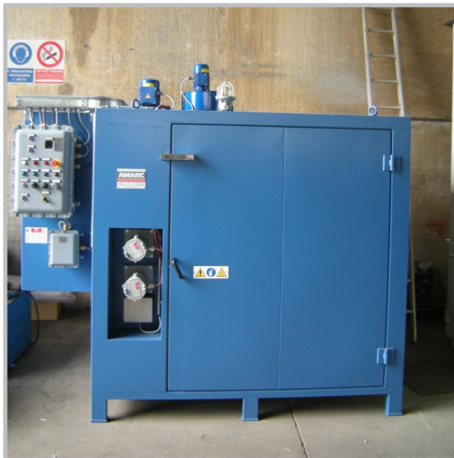
ATEX godkendt varmeovn til 4 tromler. Bundramme på ben og udluftnings system. Elektrisk drevet, med temperatur op til 150°C.
