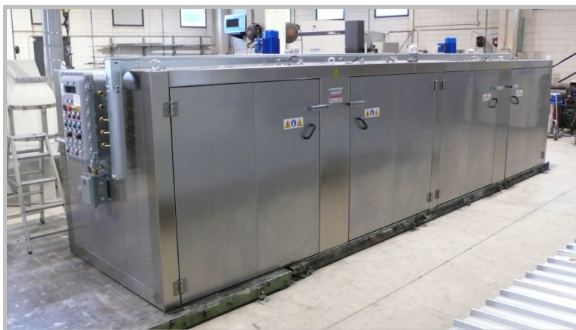
(1/2) Forside Horisontal varmeovn til 16 tromler, opdelt i 2 kamre til hver 8 tromler. Drevet af damp med temperatur op til 150°C. ATEX godkendt og AISI304 Rustfri stål konstruktion.
