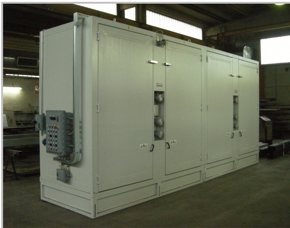
(1\2) FRONTEN Horisontal varmeovn til 32 tromler, opdelt i 2 separate kamre til hver 16 tromler. Temperatur op til 150°C, drevet af både el og damp. ATEX godkendt og med opsamlingskar.
