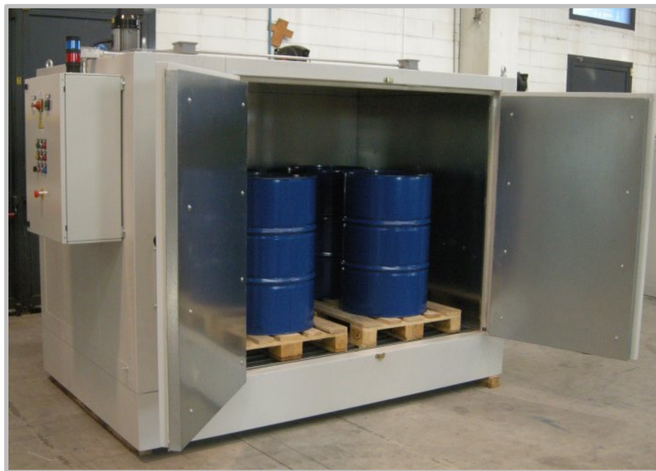
Varmeovn til 4 tromler, EUR kammer. Elektrisk drevet med temperatur op til 150°C. Her med opsamlingskar.
