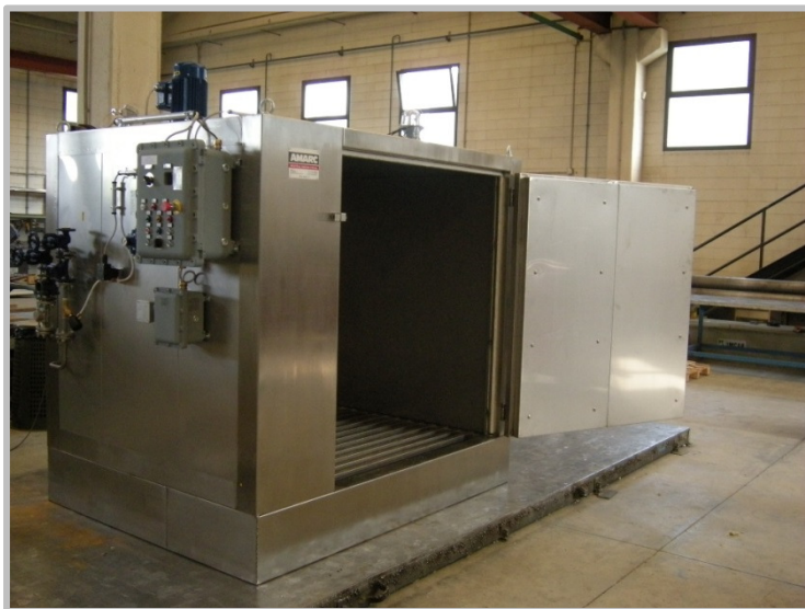
(1/2) Varmeovn til 4 tromler, op til 150°C, drives af damp, ATEX godkendt, med opsamlingskar , AISI304 rustfri stål konstruktion.
